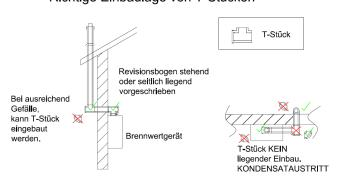
ONR 28205: Revisionsöffnung bei JEDER Richtungsänderung von 90° (ausgenommen Aufstandbogen nach oben), sowie bei NACH JEDER 2. 45° Richtungsänderung Gefälle von mind. 3°
