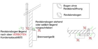
ONR 28205: Revisionsöffnung bei JEDER Richtungsänderung von 90° (ausgenommen Aufstandbogen nach oben), sowie bei NACH JEDER 2. 45° Richtungsänderung Gefälle von mind. 3°
